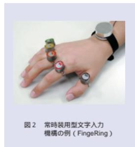
図2 常時装着型文字入力機構の例（FingerRing）
