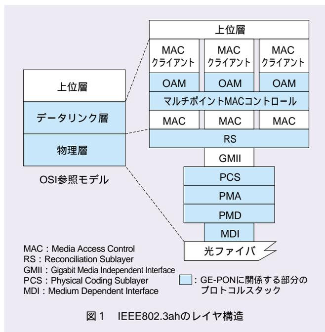
GE-PON方式では、従来の1 Gbit/sの伝送速度を持つギガビットイーサネットが標準とされていた1000BASE-Xファミリー(1998年標準化規格化タスクフォース名: IEEE802.3z)とは別に、GE-PONで必要となるバースト信号の送受信を考慮した1000BASE-PX規格が追加されました。PX規格は伝送距離(10 km対応/20 km対応)と上り・下り方向それぞれの合計4種類に分類されます。使用波長帯域は1.55 μm帯による映像の多重を考慮して、1.49 μm帯〔OLT (Optical Line Terminal) ONU (Optical Network Unit)〕および1.31 μm帯 (ONU OLT) を用います。波長多重により双方向それぞれ1 Gbit/sの通信速度(物理信号速度は1.25 Gbit/s)で通信を行います。
