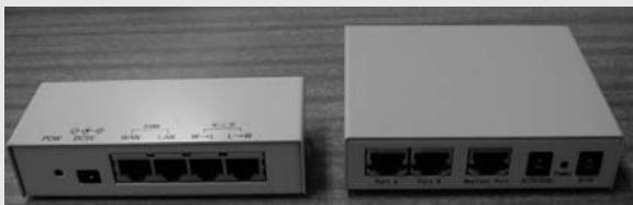
図2 リピータ型TAP (左) とスイッチ型TAP (右)
