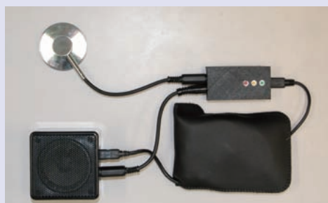
(a) ワークショップで使用した機材。聴診器、振動スピーカ（心臓ボックス）、信号処理回路、バッテリー
