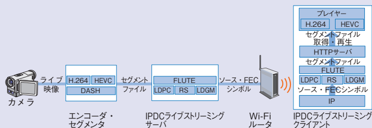
図6 IPDCライブストリーミングの送受信の仕組み
