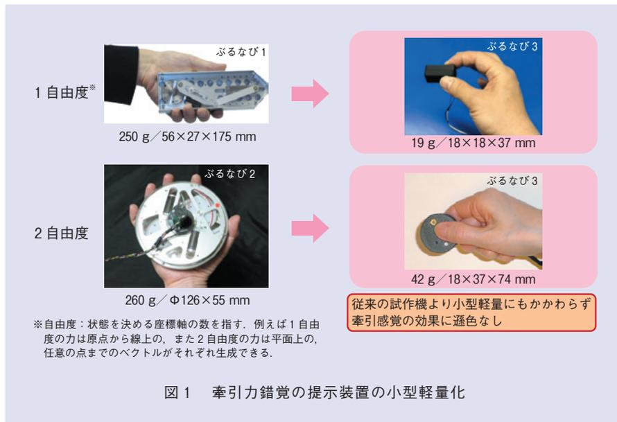
図1 牽引力錯覚の提示装置の小型軽量化
