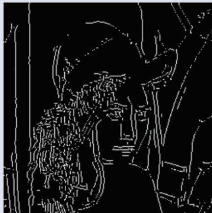
図7 Canny法によるエッジ検出
