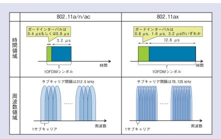
ガードインターバル: OFDMシンボル間干渉の影響を緩和するために導入されている付加時間図 1 4 倍 OFDMシンボル
