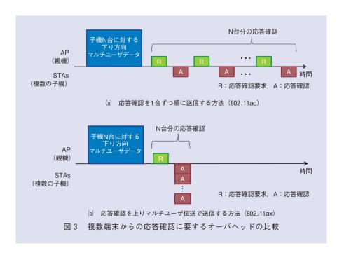
が接続されるネットワークでの通信効率改善に非常に有効な技術と考えられています(図3). また、上りのマルチユーザ伝送ではトリガフレームと呼ばれる新しいフレームを契機とすることで複数の無線LAN機器の送信タイミングを合わせて同時送信を実現する方法が議論されています.
