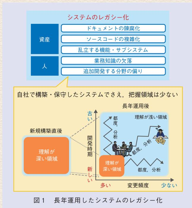
図1 長年運用したシステムのレガシー化
