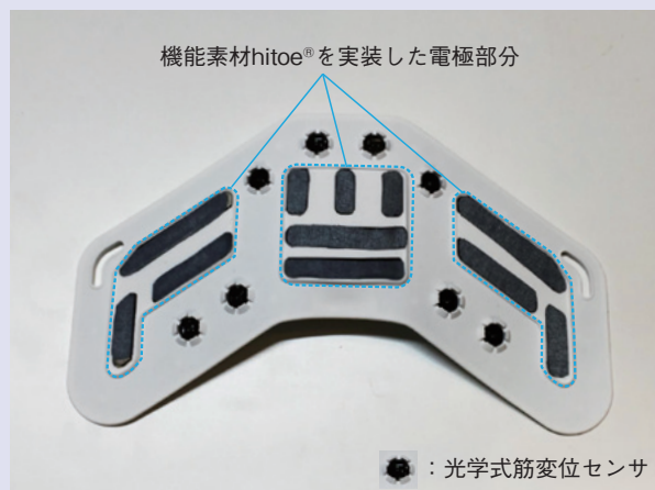
図2 機能素材hitoe®を実装したUnlimitedHand®の腕接触面
