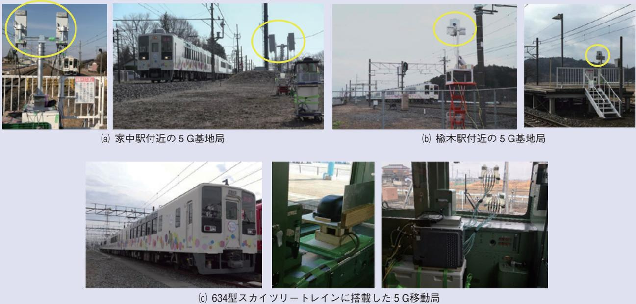
図2 東武鉄道日光線における高速移動体向け無線伝送試験
