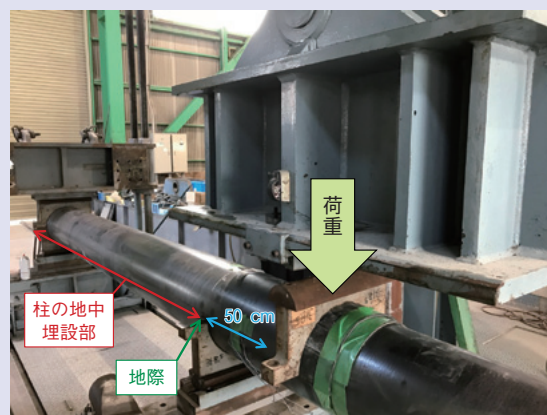
図3 横置きした柱への雪圧荷重を想定した載荷試験
