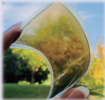
図 開発した透けて曲がる電池とLED点灯の様子
