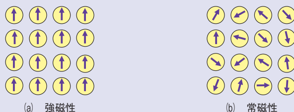
図1 強磁性と常磁性の模式図
