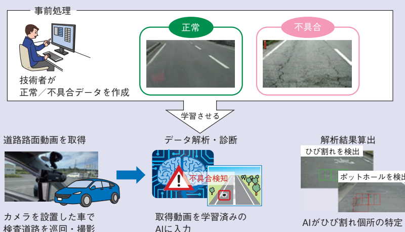
図3 ひび割れ解析ソリューション概要
