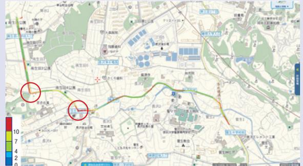
図6 路面性状測定車 IRI解析結果
