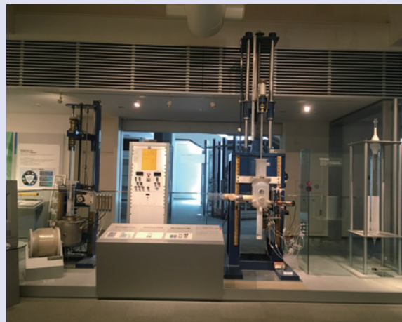
図1 VAD法光ファイバ母材製造装置
