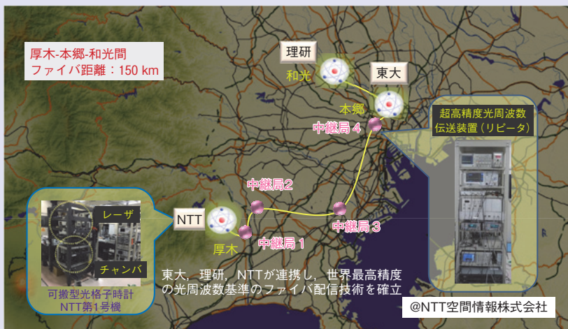
図6 光格子時計ネットワークの実証実験
