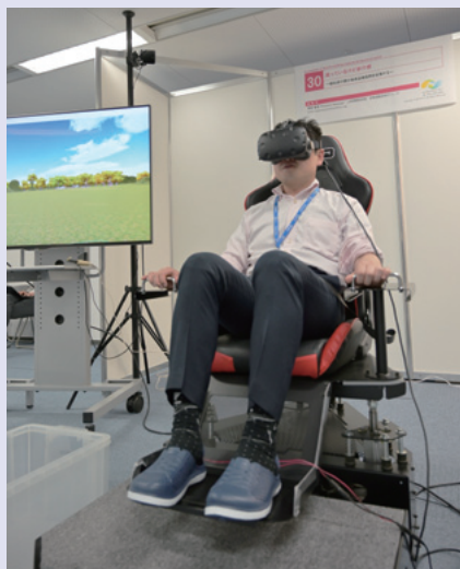
図5 身体揺動と足底振動による擬似歩行感の生成
