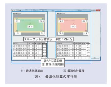
スループットが得られない場合に、本機能を活用するこ とによりスループットを改善することができます。本機 能の活用例として、10 m×20 mの屋内環境にAPが5 台設置されているケースについて手順を示します(図3). はじめに、無線LANテスタで受信強度、スループット. チャネル使用状況等の確認を行います。 今回のケースで は、すべてのAPが5GHz帯の同じチャネルを使用して いました. そこで、AP分布機能により各APの受信強 度を測定した後、置局設計ソフトウェアにおいてスルー プットのシミュレーションにより分布図を作成し最適化 計算を行います. なお. 今回は5GHz帯を利用してい ることから、レーダによる通信停止を防止する観点で W52 (チャネル36, 40, 44, 48) の帯域のみを使用する 条件としました. 最適化の結果を図4に示します. 左側 に計算前のデータが、右側に計算後の結果が表示されて います. 計算前は平均スループットが21.84 Mbit/sでし たが、置局設計ソフトウェアによる計算後に表示されて
