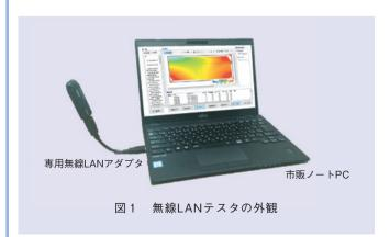
現地で解決するためのツールとして、AP検出・受信強度測定、スループット測定、AP分布表示、電磁環境モニタ、ノイズ分布表示、干渉解析、長期監視、レポート作成といった機能を具備した無線LANテスタを開発し、支店等でご利用いただいています(表1).
