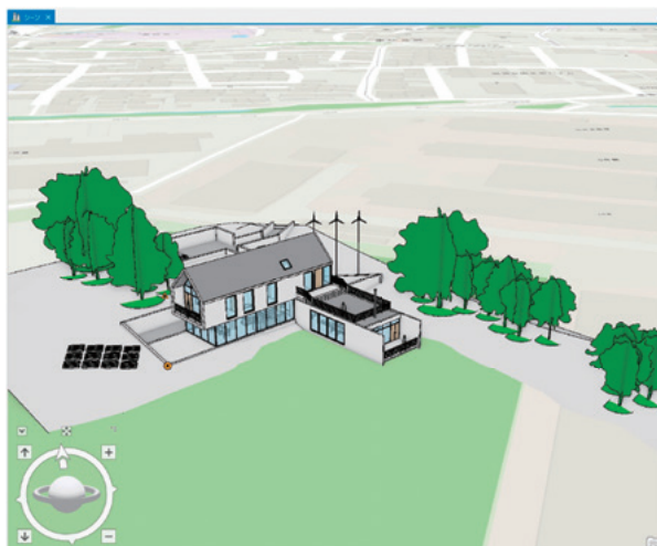
BIMツールであるAutodesk Revitの建物データ (1) (※CC BY-NC-SA 3.0)を、GISツールであるEsri ArcGIS (2) にて地図上に配置。これにより形状が正確な都市モデルの構築が可能だが、配置には手動による位置合わせが必要。
