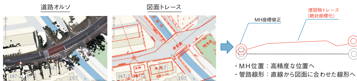
図4 紙図面の絶対座標化
