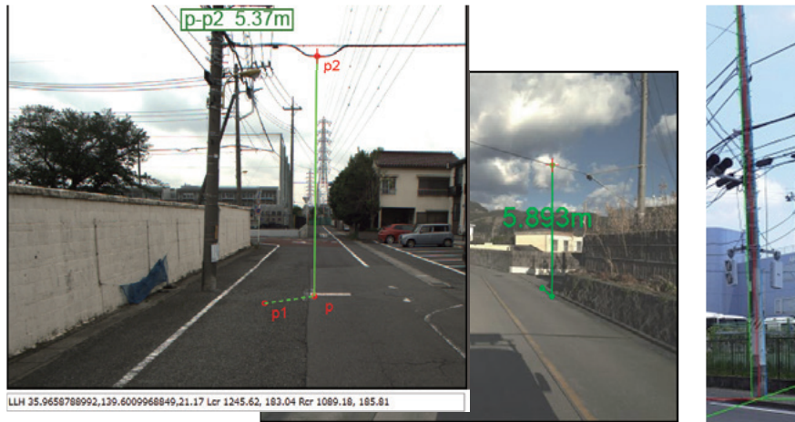
図3 ケーブル地上高計測・電柱しなり計測
