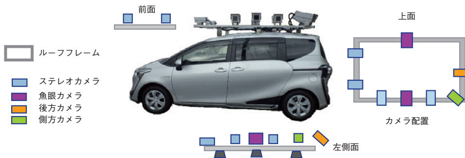
図2 当社開発のMMS（カメラ配置）
