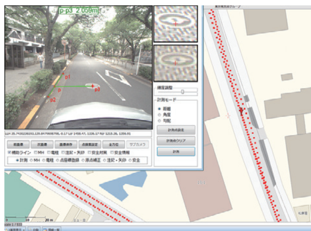
図1 MMS画像からの3次元計測 (歩車道境界からの設備までの垂直オフセット計測)
