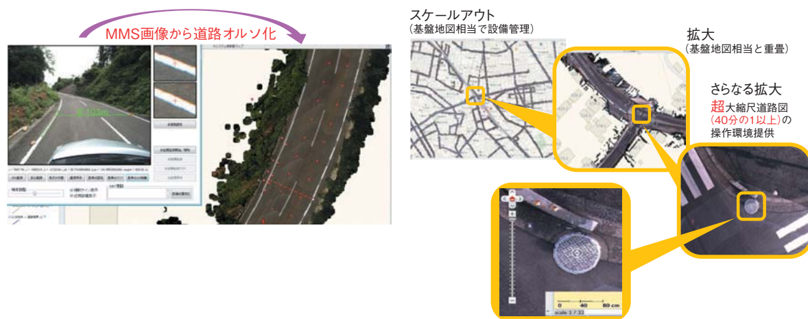
図3 MMSによる道路平面図の生成
