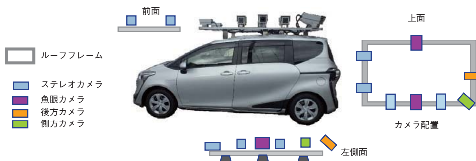
図2 当社開発のMMS（カメラ配置）
