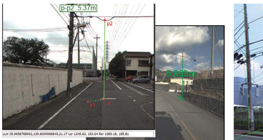
図3 ケーブル地上高計測・電柱しなり計測
