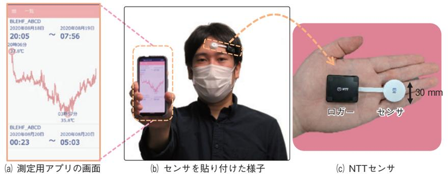
図3 NTTが研究開発を行う深部体温センサ
