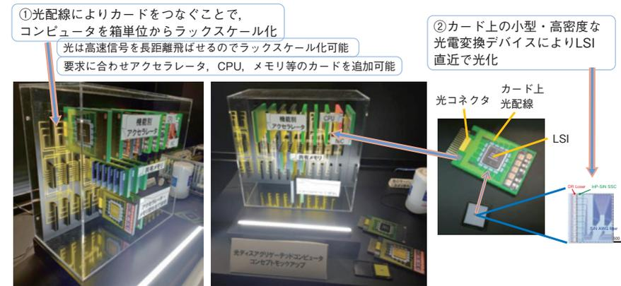
図4 ディスアグリゲータードコンピュータのモックアップ
