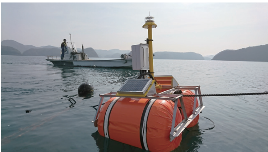
写真 対馬真珠養殖漁業協同組合で稼動中のICTブイ
