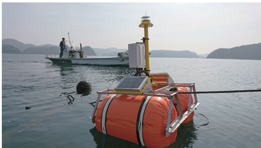
写真 対馬真珠養殖漁業協同組合で稼働中のICTブイ
