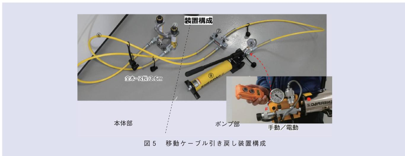
図5 移動ケーブル引き戻し装置構成
