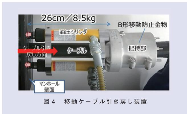
図4 移動ケーブル引き戻し装置
