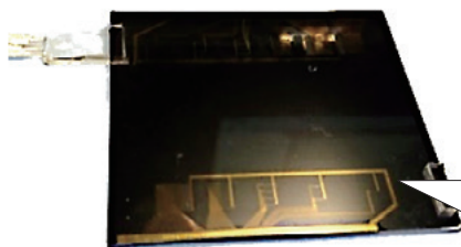
光の周波数で時間分割と重み付けする回路
