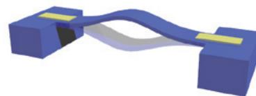
(b) マイクロ電気機械システムの一例 (模式図)。梁が両端で固定された両持ち梁 (ビーム) 構造をしています。
