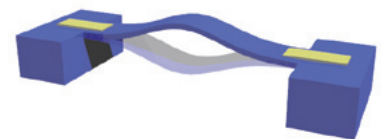
(b) マイクロ電気機械システムの一例 (模式図)。梁が両端で固定された両持ち梁 (ビーム) 構造をしています。
