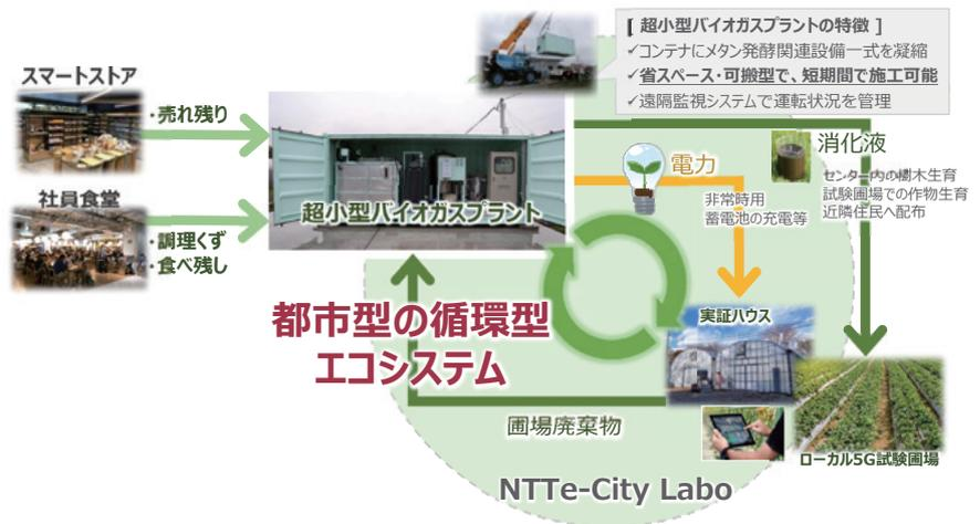
図4 都市型の循環型エコシステムの実証の概要
