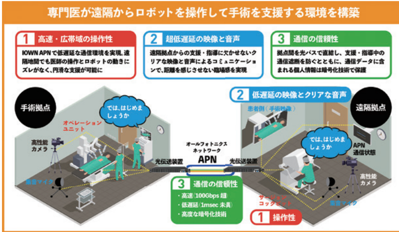
図1 IOWN APNを活用した手術ロボットの遠隔利用
