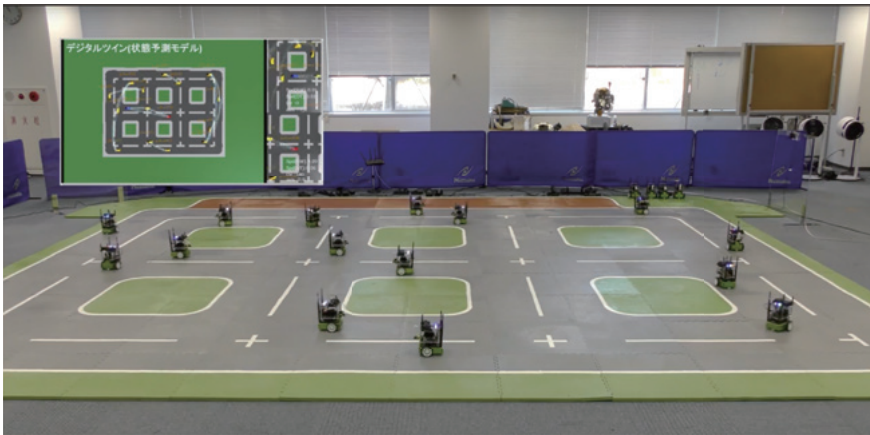
図8 シグナルフリーモビリティ：信号機を使わない分散型交通制御
