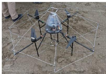
図2 開発中の耐雷ドローン
