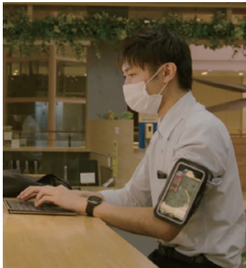
図2 試作中の非侵襲グルコースセンサを腕に装着した様子
