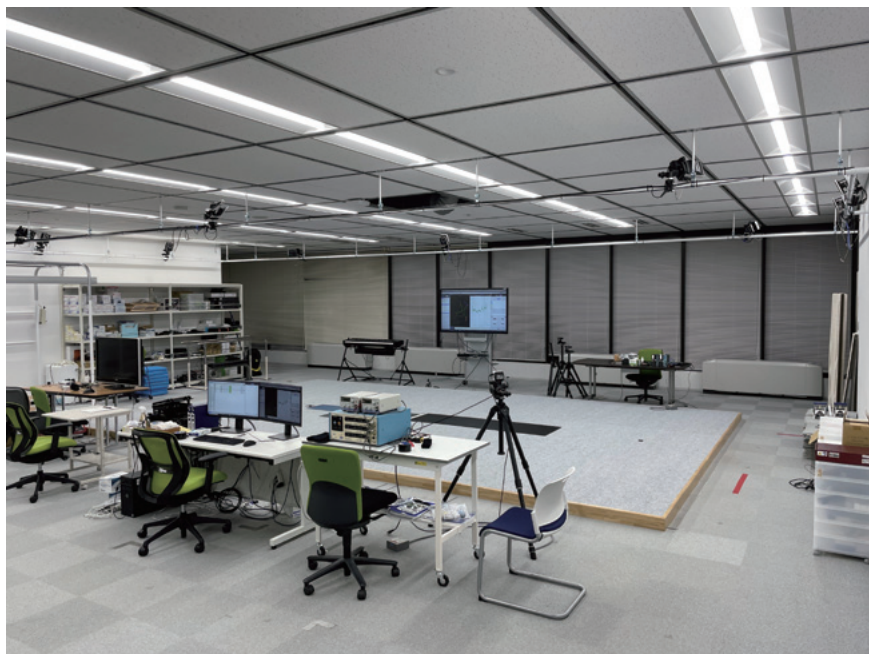
図2 計測装置（医療機器認定された計測システム） VICON モーションキャプチャ（カメラ11台）、DELSYS筋電センサ、AMTI床反力計など
