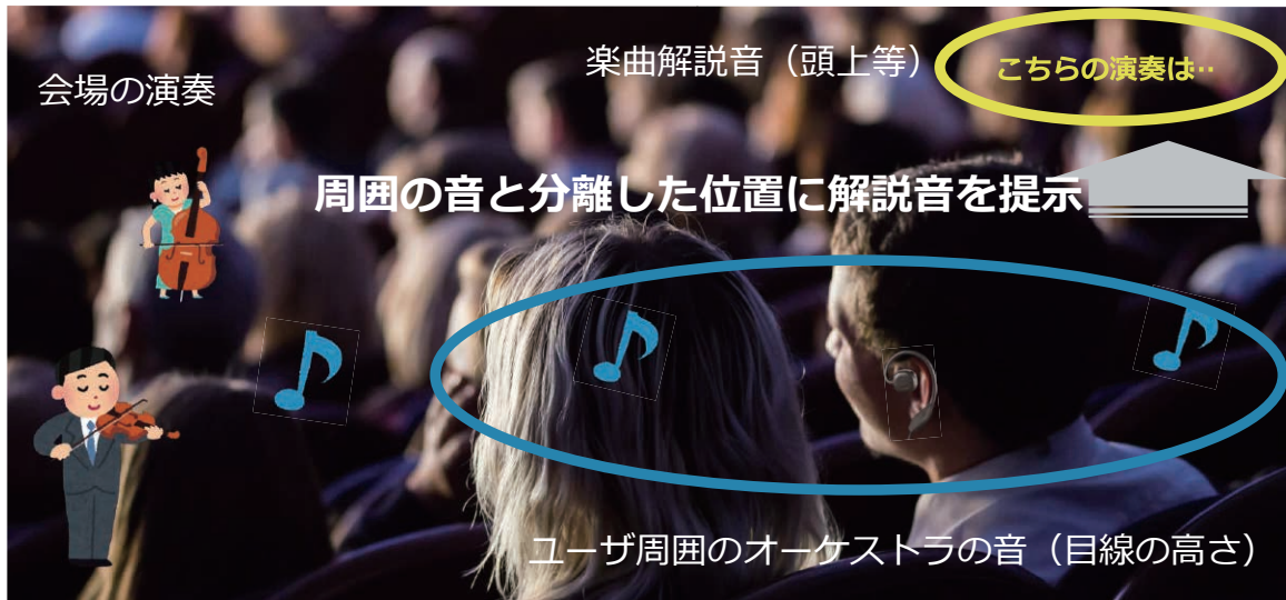
図3 空間的な特性を利用してイヤホンからの音を聴き取りやすくする音源配置技術
