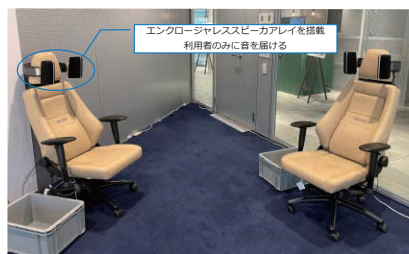
図2 ヘッドレストにPSZのエンクロージャレススピーカアレイを搭載したチェア
