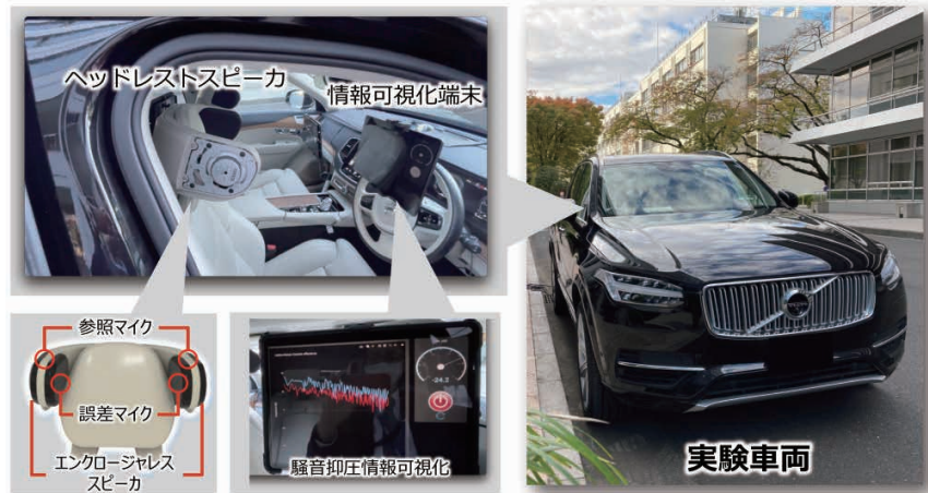
図5 耳を塞がないANCシステムの実装例
