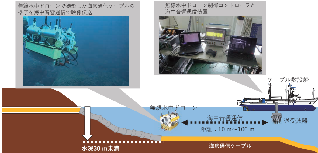
図5 完全遠隔無線制御型水中ドローンによる海底通信ケーブル点検の実証実験全体図
