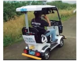
写真1 実証実験で提供している自動運転パーソナルモビリティ
