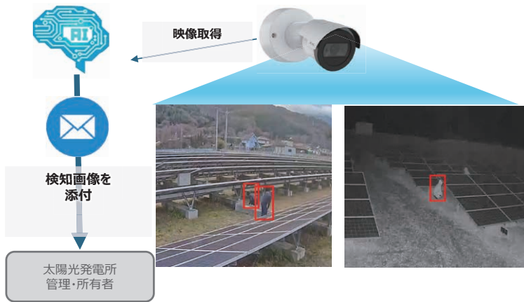
図5 太陽光発電所銅線盗難対策 AI
