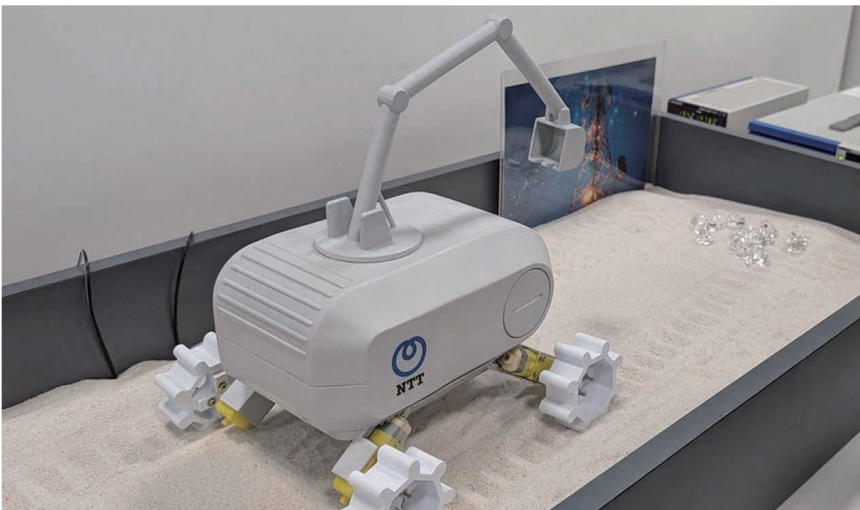
図6 「月の砂」を伝送路として、「受電器」を取り付けたローバーへ届けることで給電を可能
