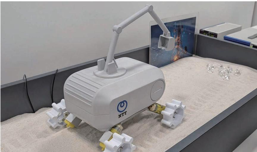
図6 「月の砂」を伝送路として、「受電器」を取り付けたローバーへ届けることで給電を可能
