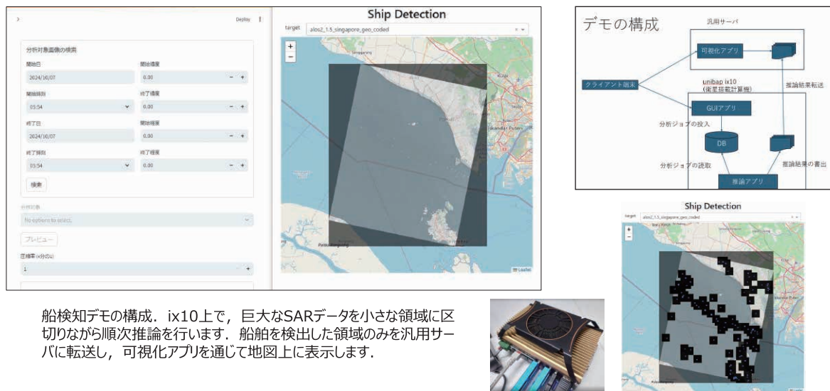
図3 宇宙向けオンボードコンピュータで動作する船検知デモ
