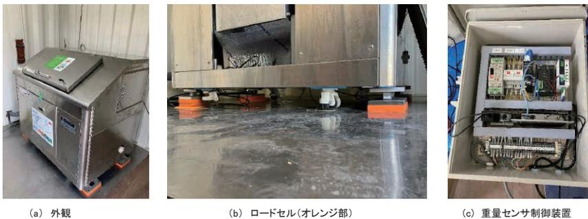
図2 発酵分解装置
