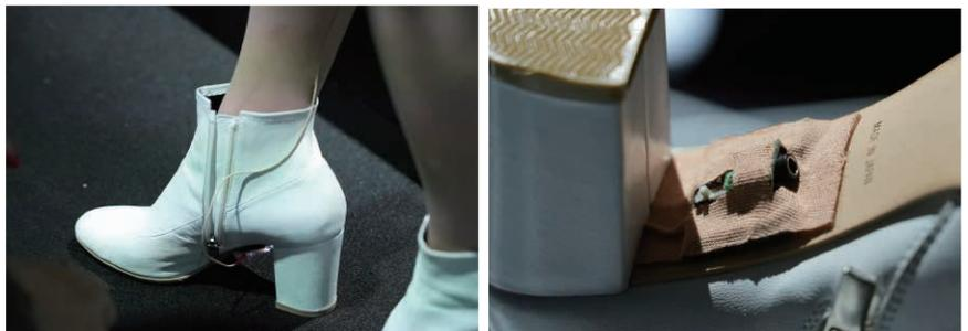
図2 足元触覚振動計測センサ
