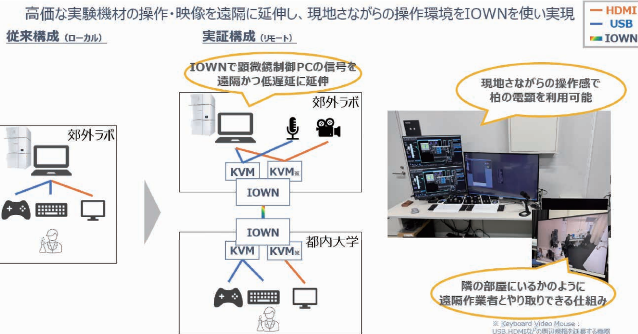
図2 電子顕微鏡の遠隔操作
