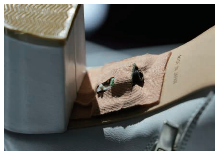
図2 足元触覚振動計測センサ
