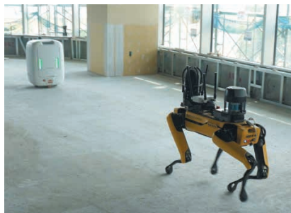
図3 四足歩行ロボット「Spot (スポット)」による建設現場の巡回作業 (実証実験より)
