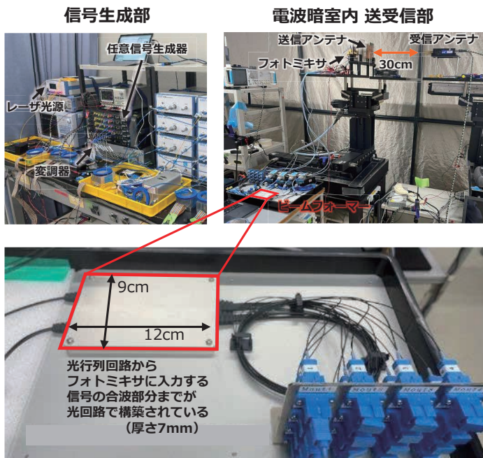
図4 平面光回路による小型のビームフォーマと測定の様子
