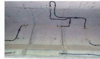
写真-4 支間中央部におけるセンサ配置状況
