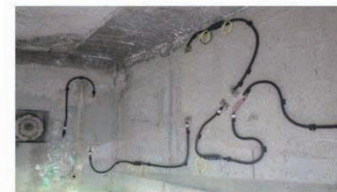
写真-3 桁端部におけるセンサ配置状況
