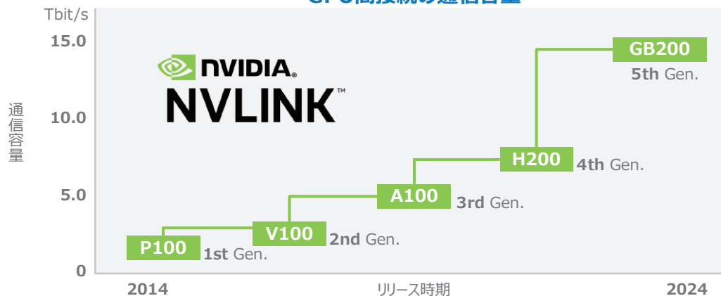
図2 AI用コンピュータに求められる通信の容量
