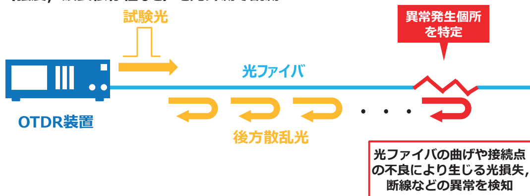
図2 異常発生検出など保守用途で使用する光計測技術 (OTDR)
