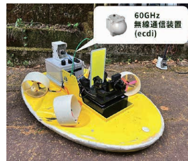
図3 カメラ搭載式ボート型ドローンと60 GHz無線通信装置(eccli*2)
