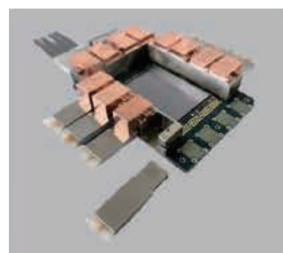
図7 ソケット型実装
